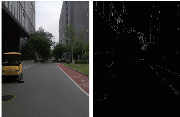
(a) 原始图像 (b) Canny 边缘检测结果图
